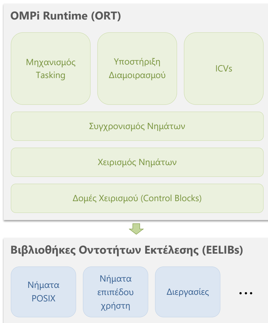
Σχήμα 3.2: Η δομή του OMPI runtime για τον host
